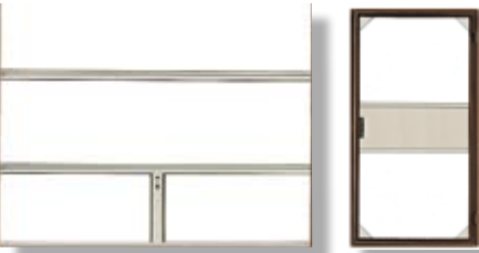
Rám výklopnej brány a vedľajších dverí Brána pre vyplnenie na mieste, max. 7kg/m2, so soklovým plechom, rám pokrytý plastom
